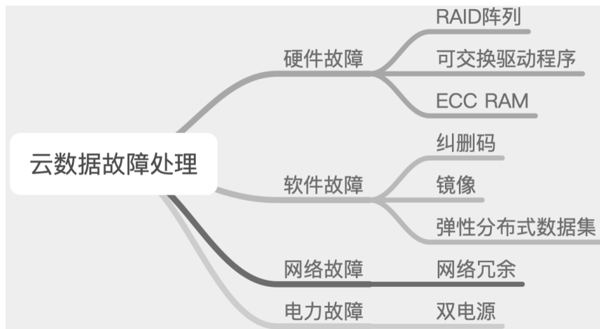
图 3 云数据中心的故障处理
